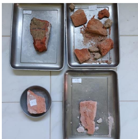
Slika 1: Ugotavljanje vlage v vzorcu po SIST EN ISO 17892-1
